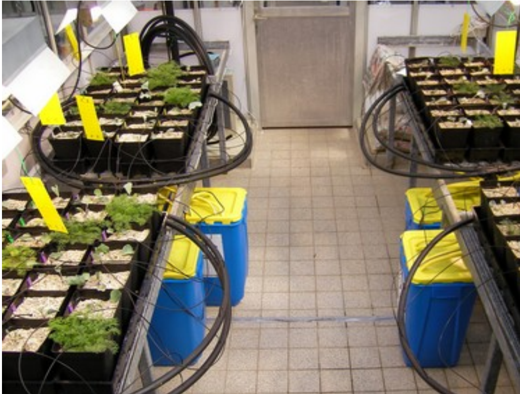
Foto 13. Overzicht van de proefopstelling aan de Vrije Universiteit Amsterdam. Met behulp van een circulair druppelirrigatiesysteem, welke continue doorloopt, worden de planten voorzien van een voedingsoplossing met een bepaalde zoutconcentratie. De planten groeien op fijn grind.
