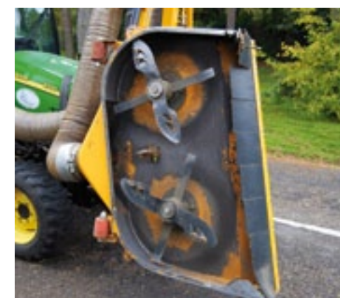
De onderste messen hebben een bocht en twee schoepjes. De bovenste rechte messen maken lang materiaal klein.
