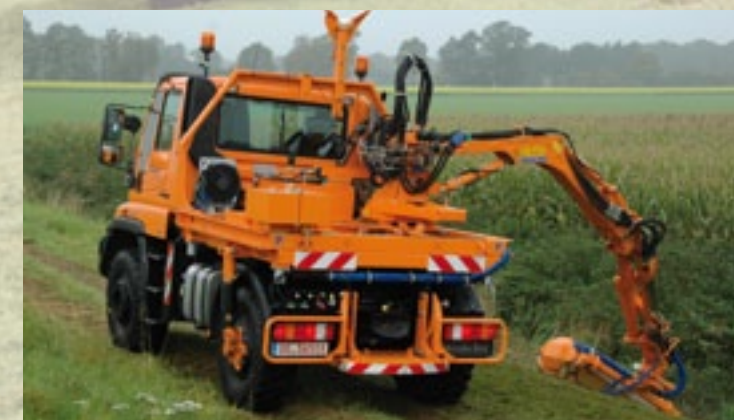
De Unimog geniet in Duitsland bij 'openbare diensten' veel populariteit en wordt dus ook, zoals hier met Mulag, ingezet bij slootonderhoud.
