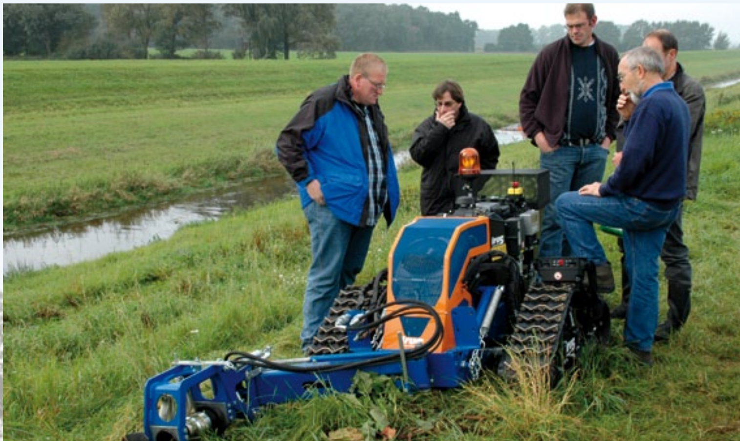
Onbemand maaien vindt op steile taluds en hellingen steeds meer toepassing. De machinist (voor zover je daar nog van kunt spreken) houdt zich letterlijk op de vlakke en de besturing geschiedt radiografisch. Deze Deltrak 2.0 van Irus kost 35.000 euro, heeft 25 kW (35 pk) en klepelt 105 of 125 cm breed.
