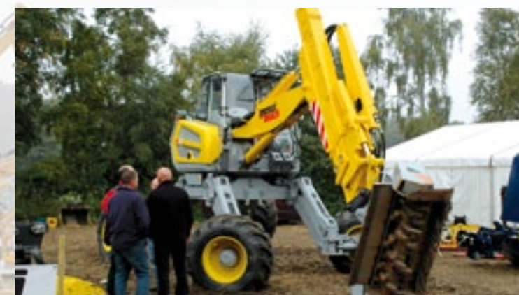
Optimale terreinvaardigheid met deze vierwiel aangedreven 'mobile kraan' van Kaiser met telescopische giek en flexibel onderstel.
