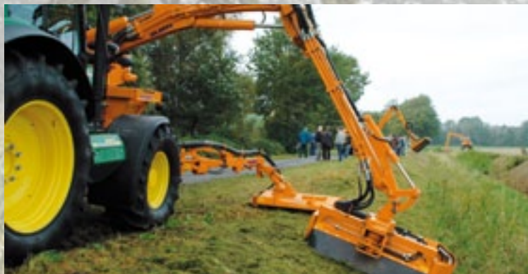
Rebo kort de motorkap van de John Deere 30-serie in. De klepelmaaier van Gilbers past zo op de vooras; een tweede maaier zit in de fronthead.
