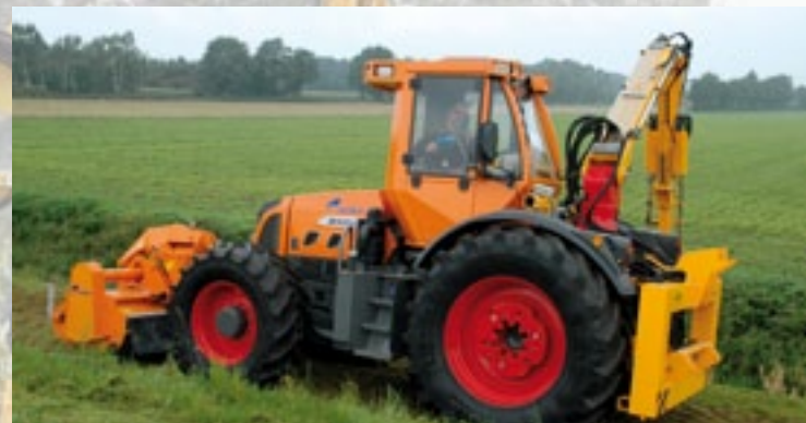
Deze Wario (op basis van Fendt Vario) heeft een draaibare cabine. De klepeltechniek op de achteras is van Herder; in de fronthead van Votex.
