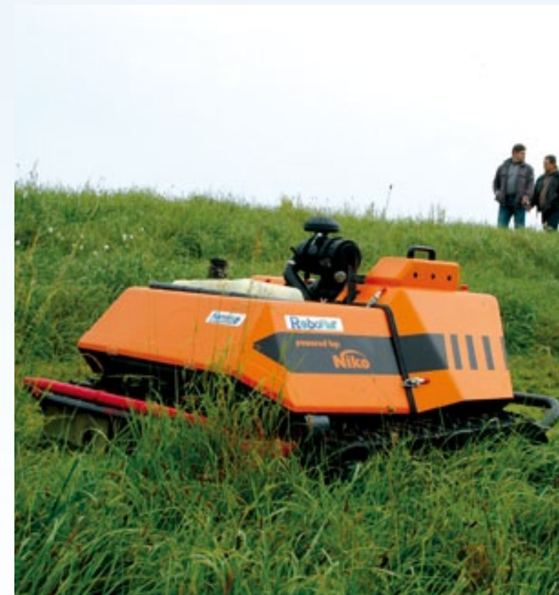
Deze onbemande Niko Roboflail met 25 pk Kawasaki heeft hydrostatische aandrijving met één oliemotor per rups. Hij maait 122 cm breed en kost 31.800 euro.
