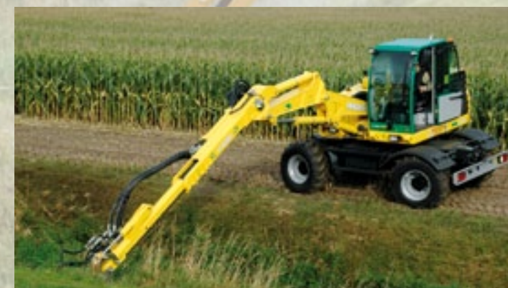
Een telescopische giek, zoals hier van Energreen, biedt de mogelijkheid om ook bij brede sloten veilig beide kanten in een keer te pakken.
