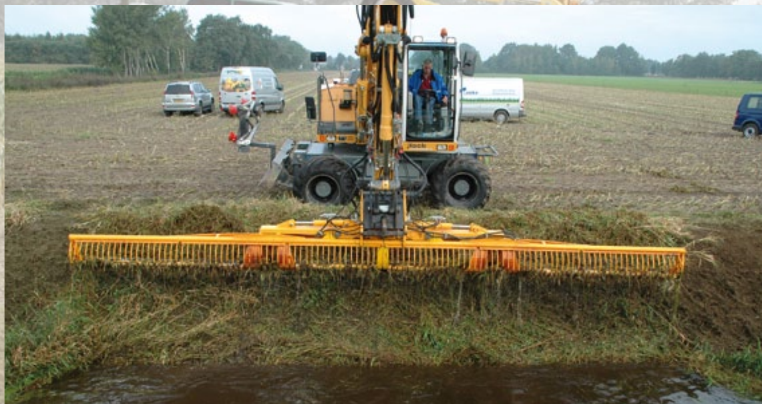
De MXZT 860 van Herder werkt 8,6 meter breed, vraagt 80 liter olie per minuut en kost zo'n 27.000 euro inclusief de opbouwtechniek in de lengte langs de giek.
