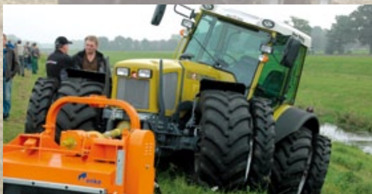
De Rigitrac heeft een axiaal lengtescharnier waardoor de neus en de vooras (en dus de fronthead) de goede positie hebben voor het werktuig.
