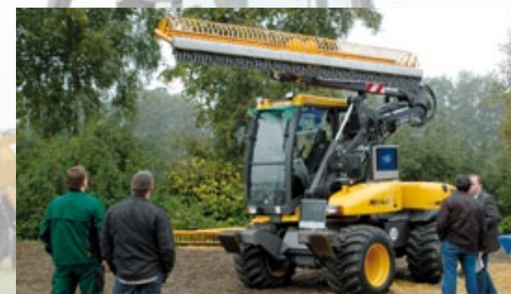
Herder vouwt de 8,6 meter brede maaikorf in twee delen op in de lengte, waardoor de openbare weg qua breedte geen problemen oplevert.
