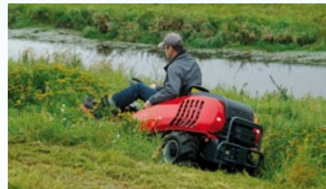
Met de chauffeur zo dicht mogelijk bij de grond is er extra stabiliteit. De Canycom 2103 met 21 pk en 90 cm dek kost 15.500 euro.
