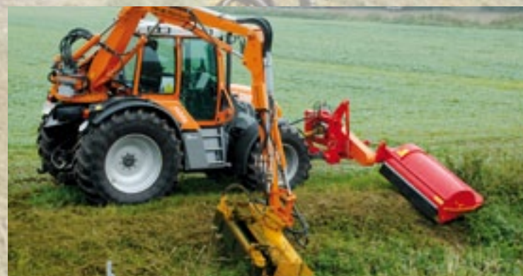
Pfanzelt verplaatst de cabine van Case IH/Steyr naar voren. Boven de stabiele achteras ontstaat zo ruimte voor het bevestigen van een arm.
