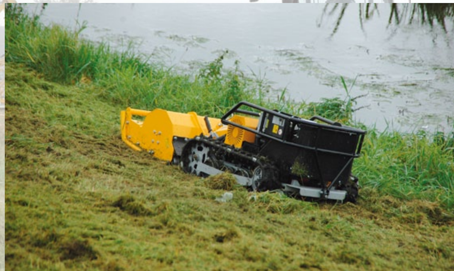
Onbemand klepelmaaien op rupsen met de MBM 75 RC van Motec. Door het ontbreken van de chauffeur zit het zwaartepunt laag. Daardoor en door het ontbreken van de factor mens, valt er op zeer steile hellingen, tot 58 graden, toch veilig te werken. De Motec heeft een 15 pk Honda en kost 21.500 euro.
