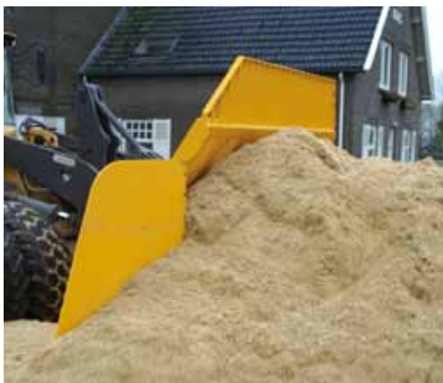
De bak heeft een inhoud van 1800 liter, voldoende om snel een vracht maïs netjes over de kuil te verdelen.
