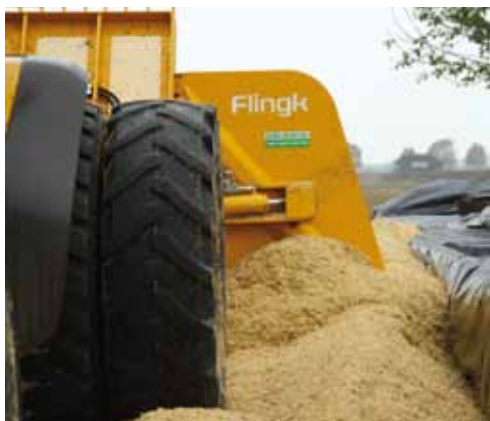
Door het heen en weer schuiven lukt het goed om tegen de wand meer maïs te lossen.
