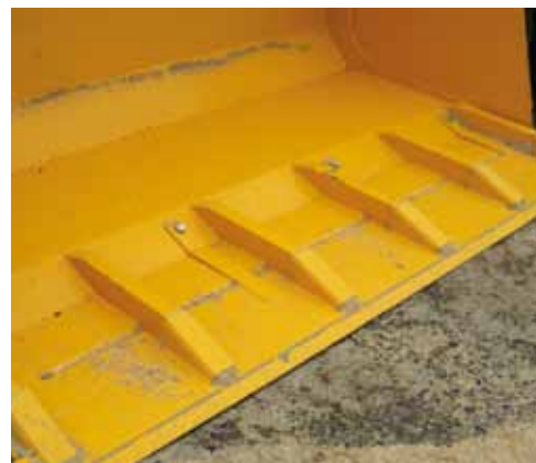
Voor gebruik in gras kan het mes worden verwijderd door het losschroeven van vier bouten.
