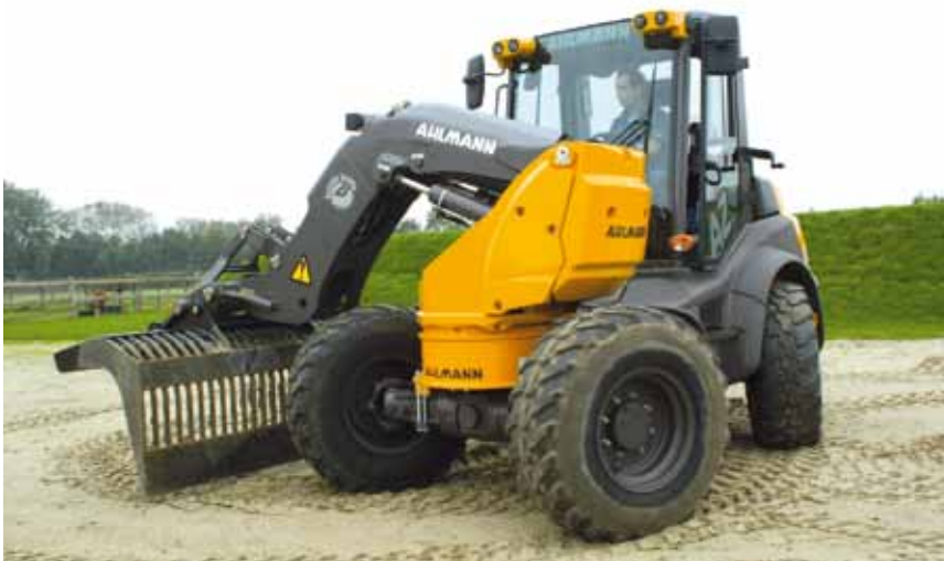
De ontwikkeling van een zwenkframe naar een half gesloten monoblok met geïntegreerde cilinders en leidingen. Beter zicht, minder kans op schade.
