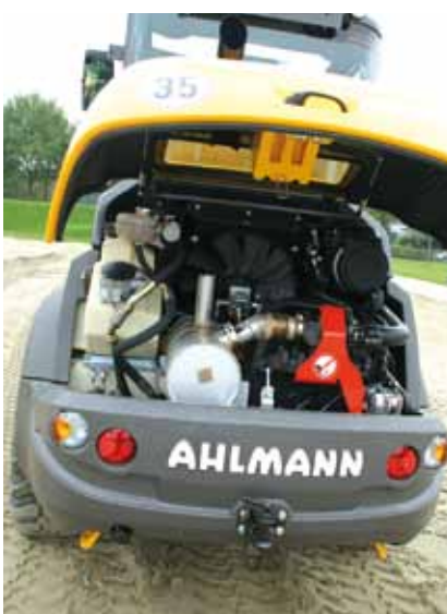
Dé verrassing van de nieuwe AZ95 is de Cummins B3.3T-turbodieselmotor onder de kap. Foto rechts: goed zicht op het werk door de grote ruiten en de dakruit.
