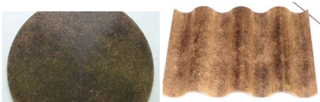
Figuur 2: Plaatmateriaal gemaakt van kokosvezels
