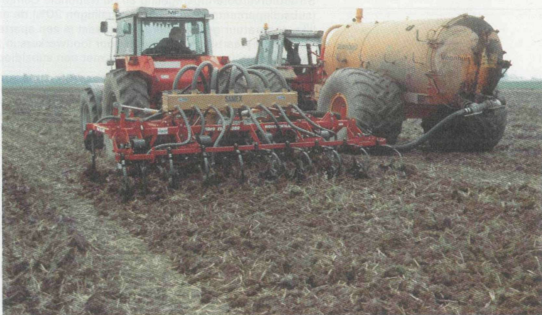
Een andere mogelijkheid om op bouwland de ammoniakemissie tijdens en na de aanwending van dierlijke mest sterk terug te dringen.
