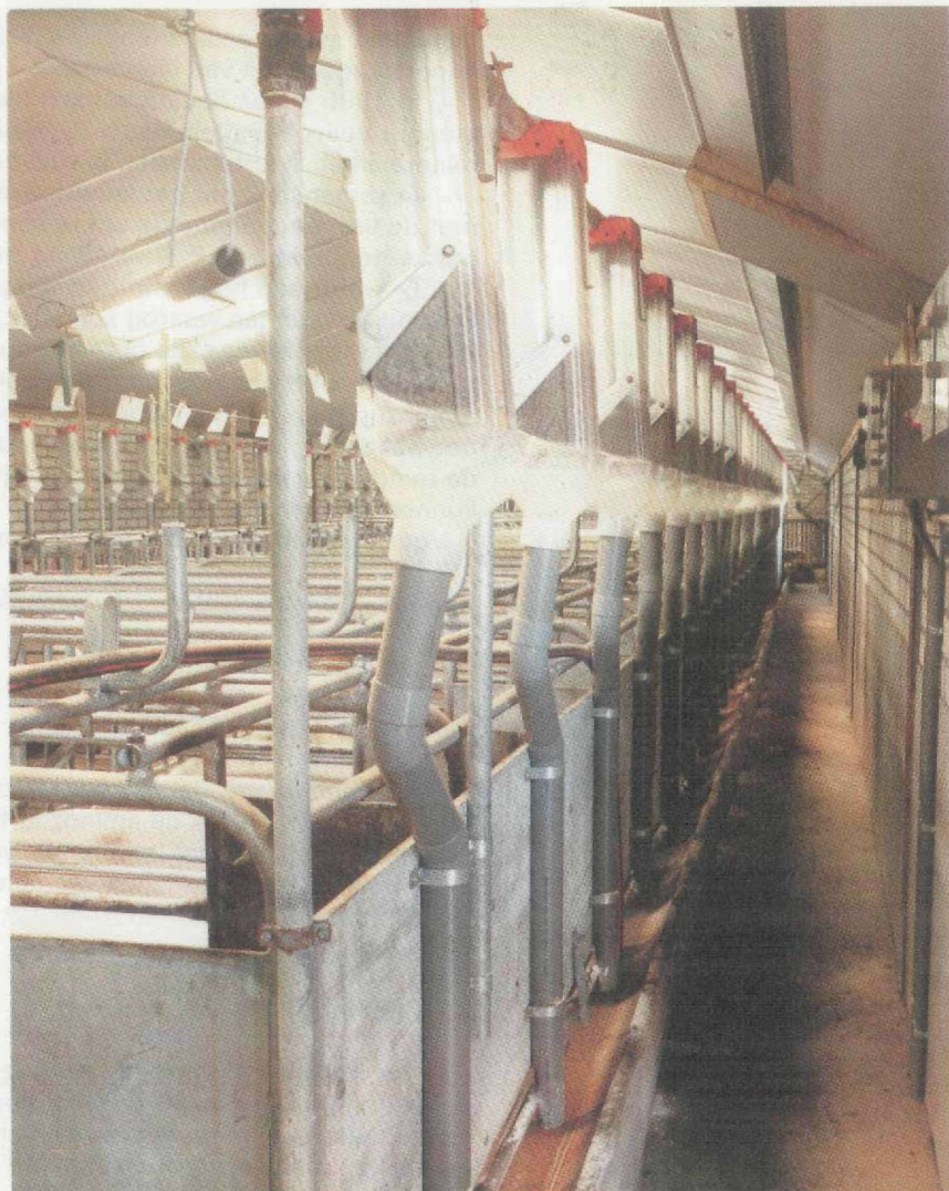
Het toepassen van een automatisch droogvoersysteem met een doseermogelijkheid per hok maakt het mogelijk dat varkens beter op de norm gevoerd kunnen worden. De mineralenuitscheiding via de mest neemt daardoor af.
