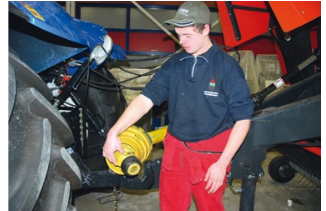
▲ Een tussenas van een pers is uitgerust met een vrijloopp koppeling. Meestal in combinatie met een slipkoppeling. Aan de trekkerzijde zit de groothoekkoppeling en aan de machinezijde de vrijloopp/slipkoppeling.
