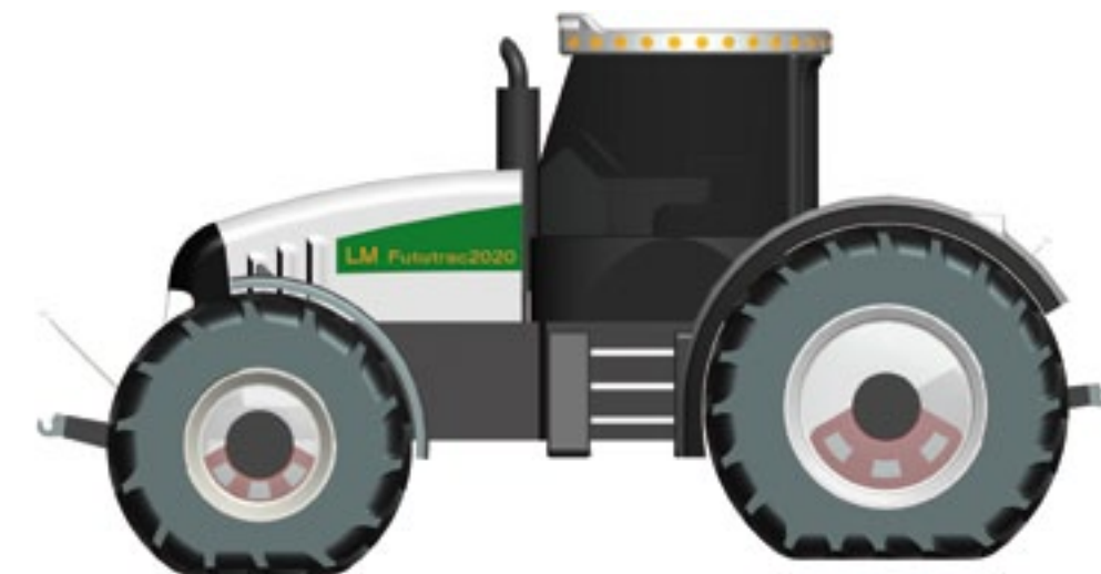
▲ Kenmerkend zijn de bij lage luchtdruk sterk afplattende banden. Samen met een automatisch bandenspanningsregelsysteem vormt dat het beste uitgangspunt voor zowel transportwerk als werk in het veld.
