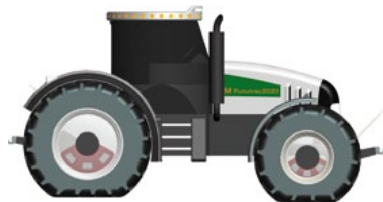
▲ Elektrische wielmotoren, hier in doorzicht getekend, krijgen hun voeding van een generator. De transmissie en de differentieel ontbreken. Een ring van krachtige oranje ledlampen neemt de plaats in van de zwaailamp.
