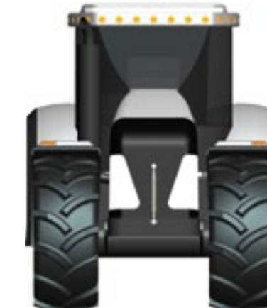
▲ De fronthef is in de neus geïntegreerd. De koplampunits herbergen rijverlichting en verstralers. Breedtelampen zitten op de spatborden.
