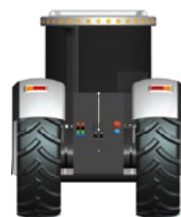
▲ Elektrische aansluitingen nemen de plaats in van hydraulische. De hef is 'zelfzoekend' en de mechanische aftakas een optie.
