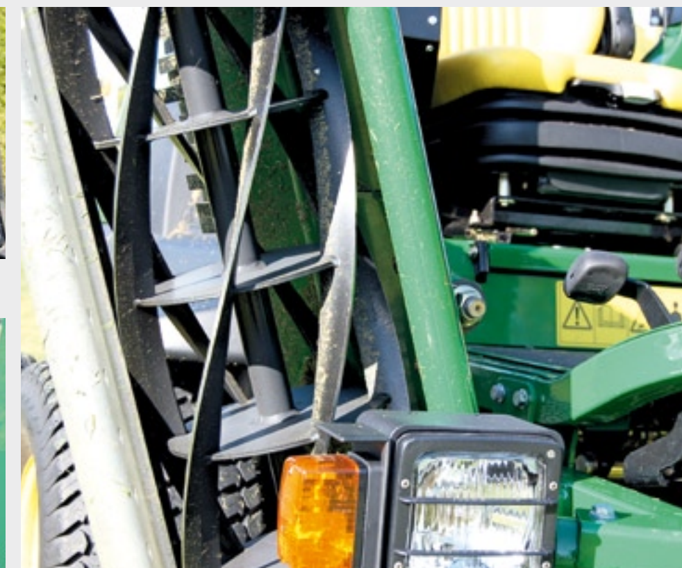
De Jumbokooien met een grote diameter en zes snijbladen kunnen ook lang gras aan. De kooien hebben dubbele torsiebuizen voor meer starheid en minder onderhoud.
