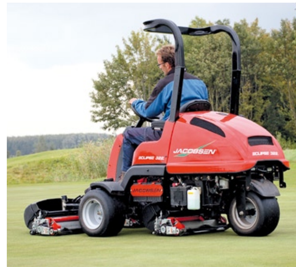
Bij de Jacobsen Eclipse 322 greenmaaier zijn alle functies elektrisch, alleen de krachtbron kan een brandstofmotor zijn. Voordeel bij deze hybrideversie is het lagere brandstofverbruik.
