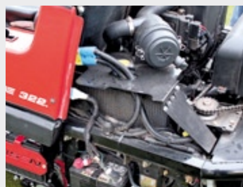
De blauwe stekker met elektrische kabels haalt de stroom uit een generator met kleine buffer accupakket of volledig accupakket.
