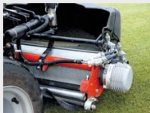
Bij het prototype is de aansluiting op de elektromotor van de kooi nog met een stekker, dit wordt een stevigere schroefkoppeling.
