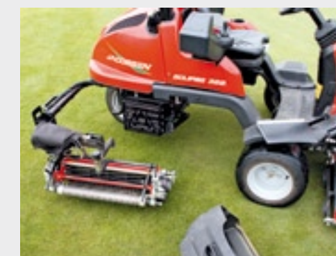
Door de swing-out-arm is onderhoud aan de middelste kooi gemakkelijk.
