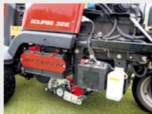
De motor met generator levert stroom aan een buffer accupakket (links achter Jacobsen plaat). De accu rechts is voor het starten.
