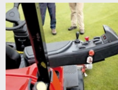
De armleuning is naar buiten te draaien zodat je aan beide kanten kunt opstappen. Met de joystick bedien je het heffen en zakken.
