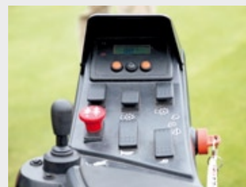
Via een lcd-schermje kun je diverse functies instellen. Met de drie schakelaars eronder is elke kooi apart in te schakelen.
