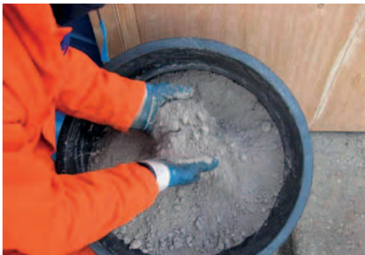
FIGUUR 4 STRUVIET GEPRODUCEERD IN HET BETUWSE KUNSTMESTPROJECT
