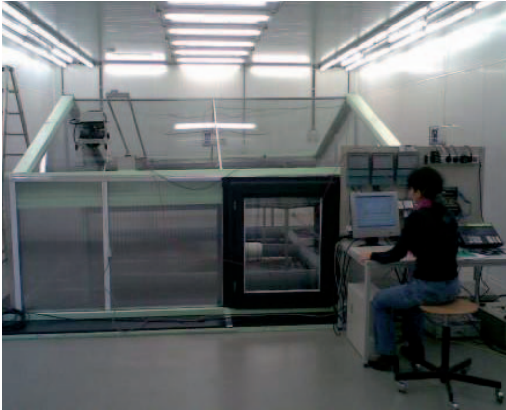
Figuur 1. Impressie van het kasje met de venlokap en de meetopstelling in de klimaatkamer
