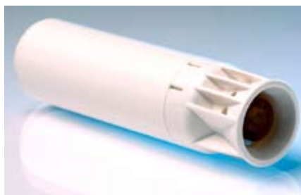
De pH-bolus verzendt draadloos gegevens over zuurtegraad en temperatuur in de pens
