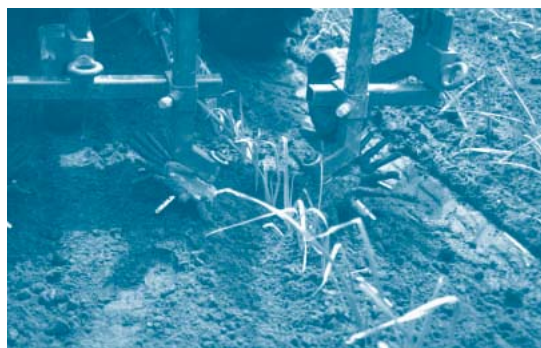
Onkruid in de rij kan in prei en broccoli goed bestreden worden met vingerwieders. Door een gerichte keuze van gewassen en teeltsystemen is dezelfde apparatuur in meerdere gewassen te gebruiken
