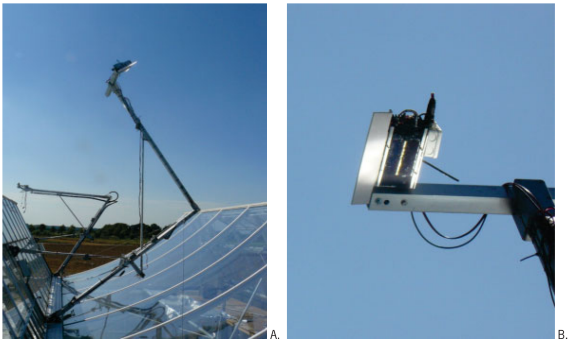
Figuur 3.1. A. Meetmodule gemonteerd aan de middelste arm. B. Detail van de meetmodule met twee Silicium PV-cellen.
