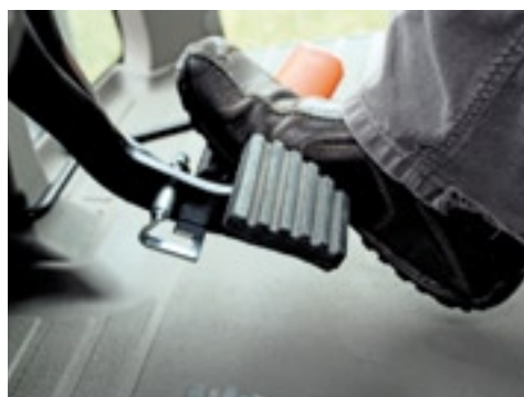
▲ De twee rempedalen worden elektronisch automatisch gekoppeld boven 20 km/h.
