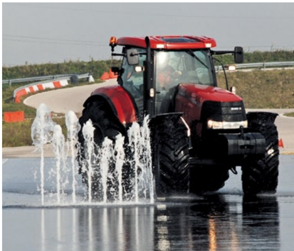
▲ Het ABS-remsysteem van de Case IH bestaat uit een pneumatisch deel dat via een omzetter de hydraulische remmen van de trekker activeert. Het houdt de trekker ook op een heel glad wegdek bestuurbaar.
