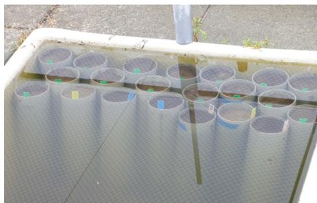
Proefopstelling: buizen met grond met verschillende besmettingen met aaltjes, in inundatiebak
