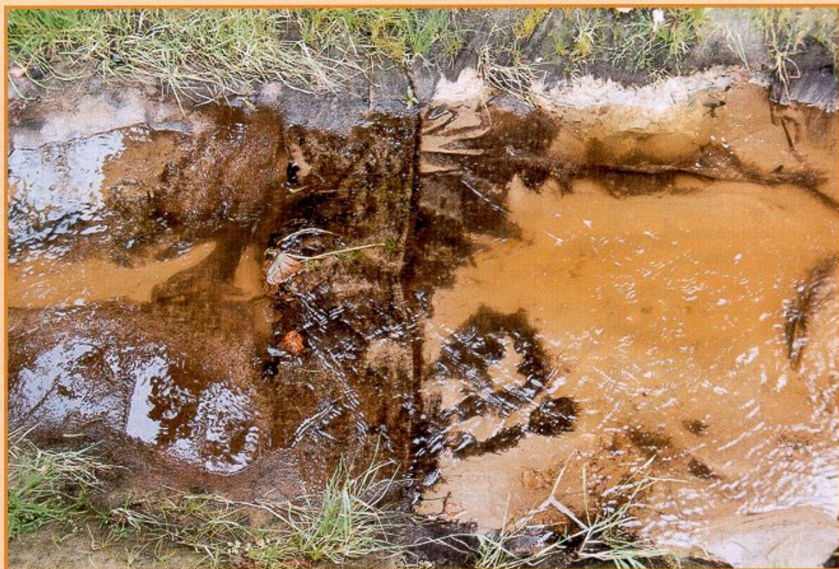
Geacetyleerd (links) en onbehandeld juteweefsel op de bodem van een beek na 15 weken van de veldtest (juli 1999)
