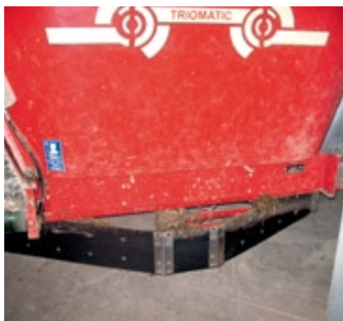
Een voerschuifje onder de mengkuip is een optie. Een kabel laat de schuif in de werkstand zakken op de gewenste plaatsen.
