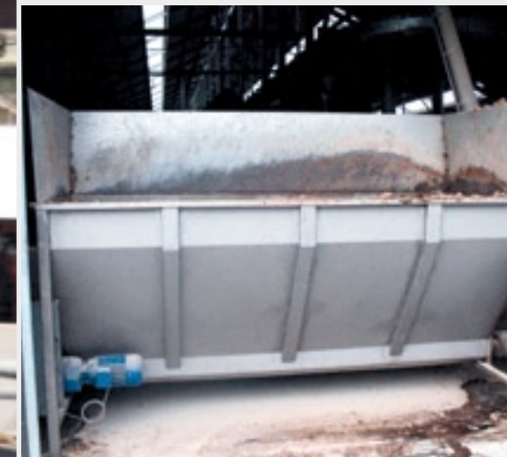
De rvs bak voor bijproducten is uitgevoerd met een vijzel die in de voerrobot lost.
