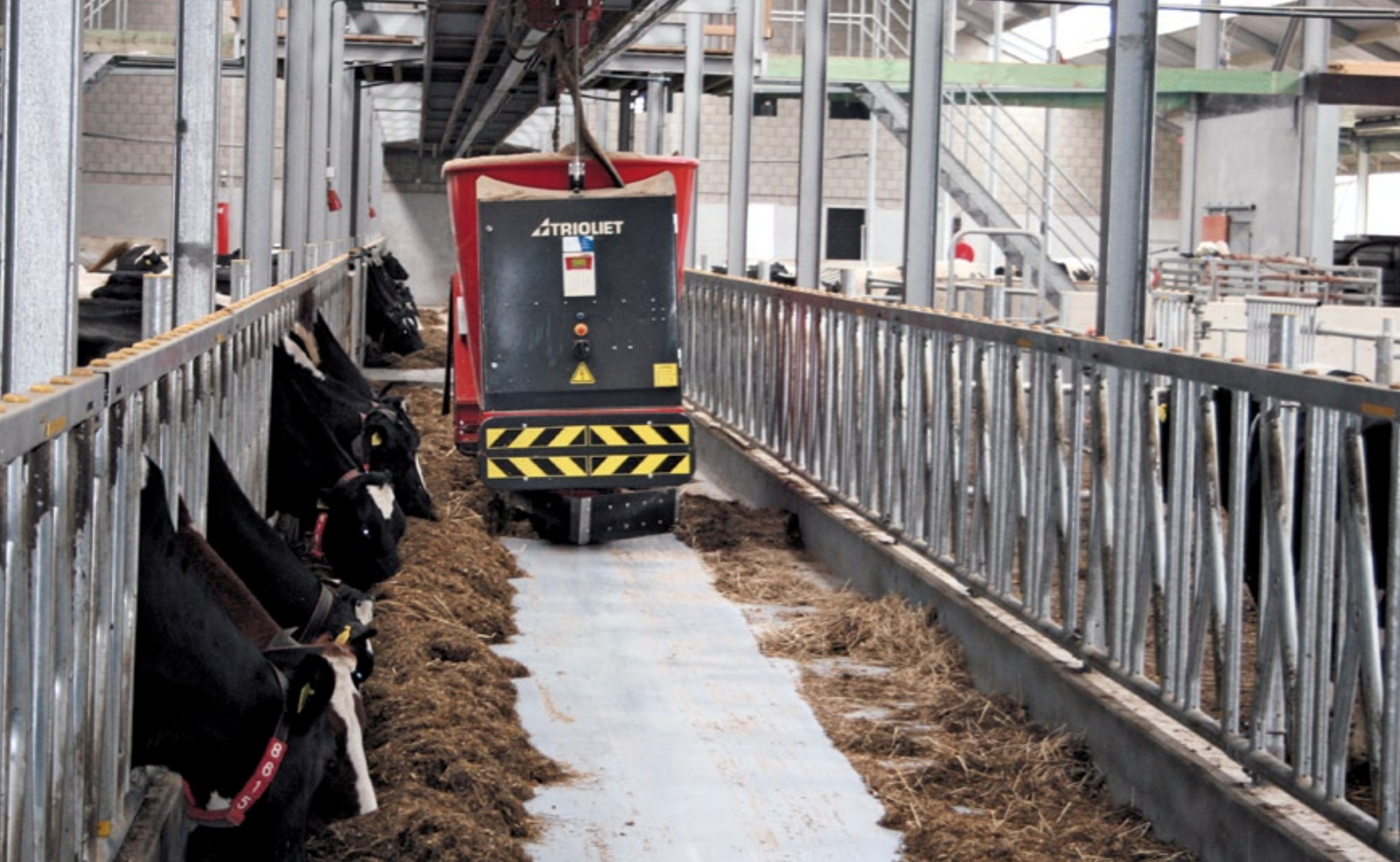
De rvs bak voor bijproducten is uitgevoerd met een vijzel die in de voerrobot lost.
