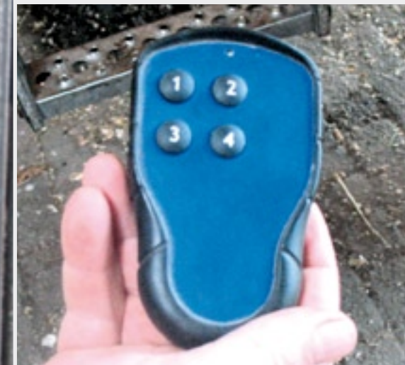
Met de afstandsbediening bedien je de rolbodem tijdens het vullen van de bunkers. Zo kun je bunkers gelijkmatig vullen.
