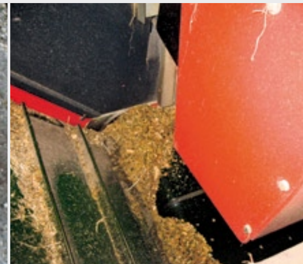
Tussen de transportbanden hoort voer op. De fabrikant past dit voor de te leveren installaties nog aan.
