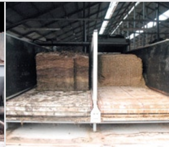
In de bunkers kun je het voer los storten of met pakken op de rolbodem zetten. Je kunt de bodem terugdraaien voor het vullen.
