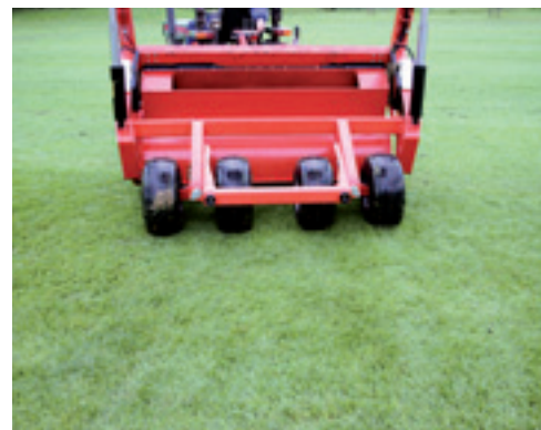
De vier wielen zijn per tweetal pendelend opgehangen en hebben dus goede bodemvolgende eigenschappen.
