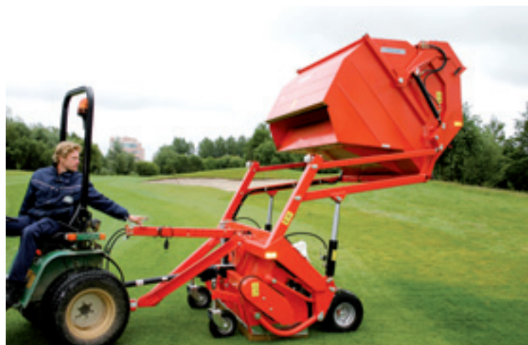
Het parallellogram tilt de container op en brengt deze achter de wielen. De schuine bodem zorgt ervoor dat materiaal soepel uit de container schuift.
