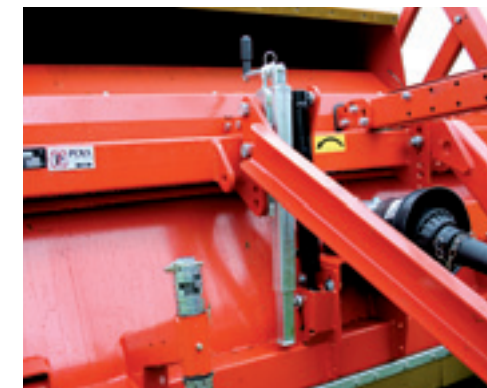
Om de machine op dezelfde hoogte aan te koppelen als dat je hem hebt weggezet, is een vestelbare steun voorop de machine geplaatst. De steunwielen van de opraper staan op de grond en de opraper drukt dus tegen de steun.
