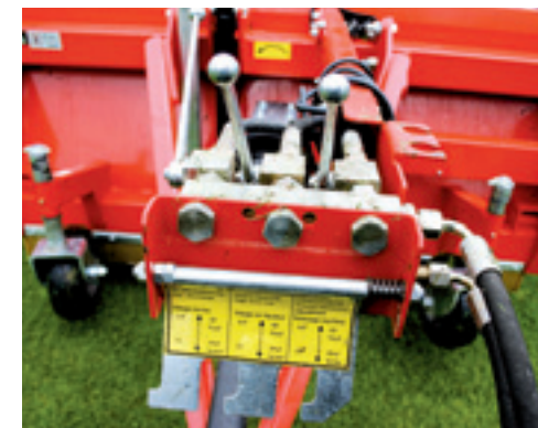
Drie bedieningskranen zorgen voor de hydraulische functies van de Wiedenmann. Twee voor de container en een voor de opraper.
