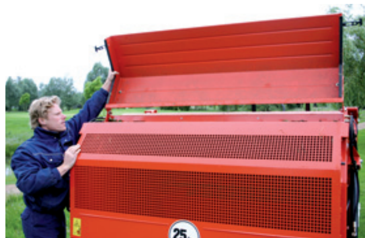
Om de luchtstroom in de container te veranderen, kun je de bovenste kap openzetten.
