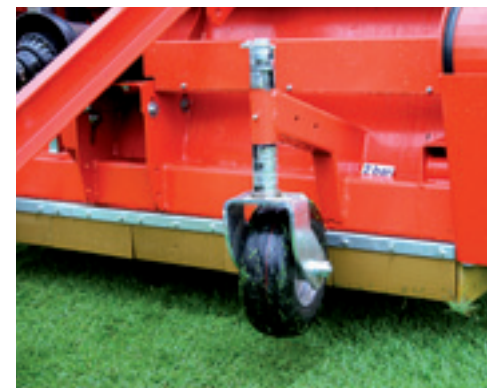
Voorop de machine zijn twee stelwielen geplaatst. Door middel van het uitnemen van ringen kun je de werkhogte instellen.
