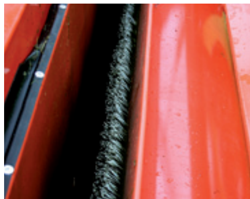
Golfvereniging Leeuwenbergh maakt gebruik van een borstel op de Wiedenmann. Deze zit goed verscholen onder de machine.
