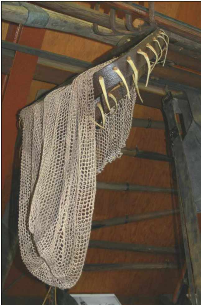
Met een baggerbeugel, die aan een lange stok was bevestigd, werd het veen onder de waterspiegel opgebaggerd.
