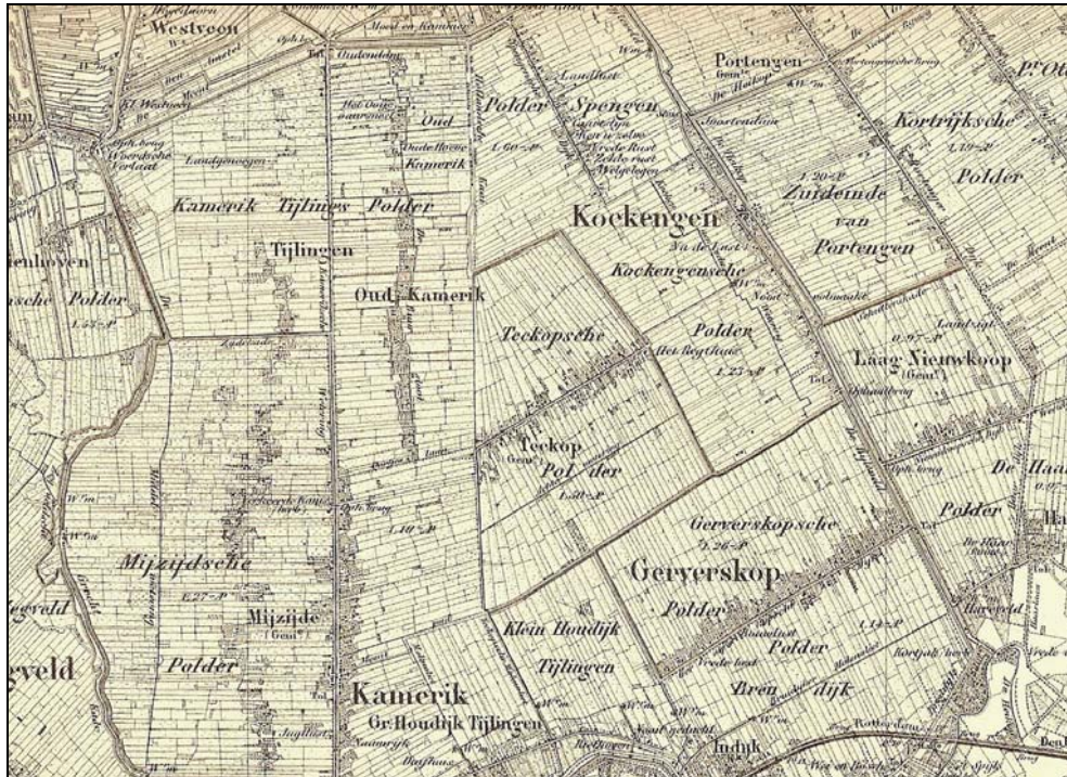
Ten noorden van Woerden ligt het meest uitgebreide complex cope-ontginningen van ons land. De rechthoekige vormen van de dorpsgebieden en de strakke systematische indeling van de kavels getuigen van de vaardigheid van de middeleeuwse landmeters. Bron: Militaire en Topographische Kaart van het Koninkrijk der Nederlanden 1850-1864.
