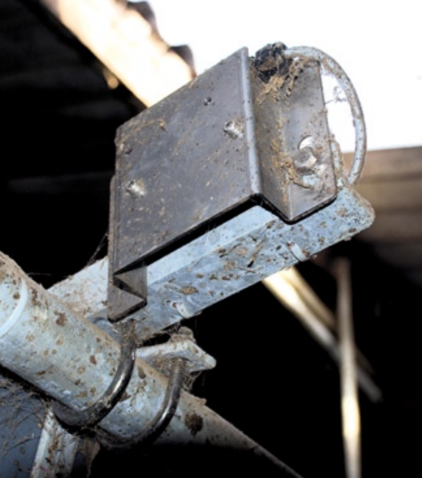
Een fotocel ziet of de koe door de poort is of blijft wachten.
