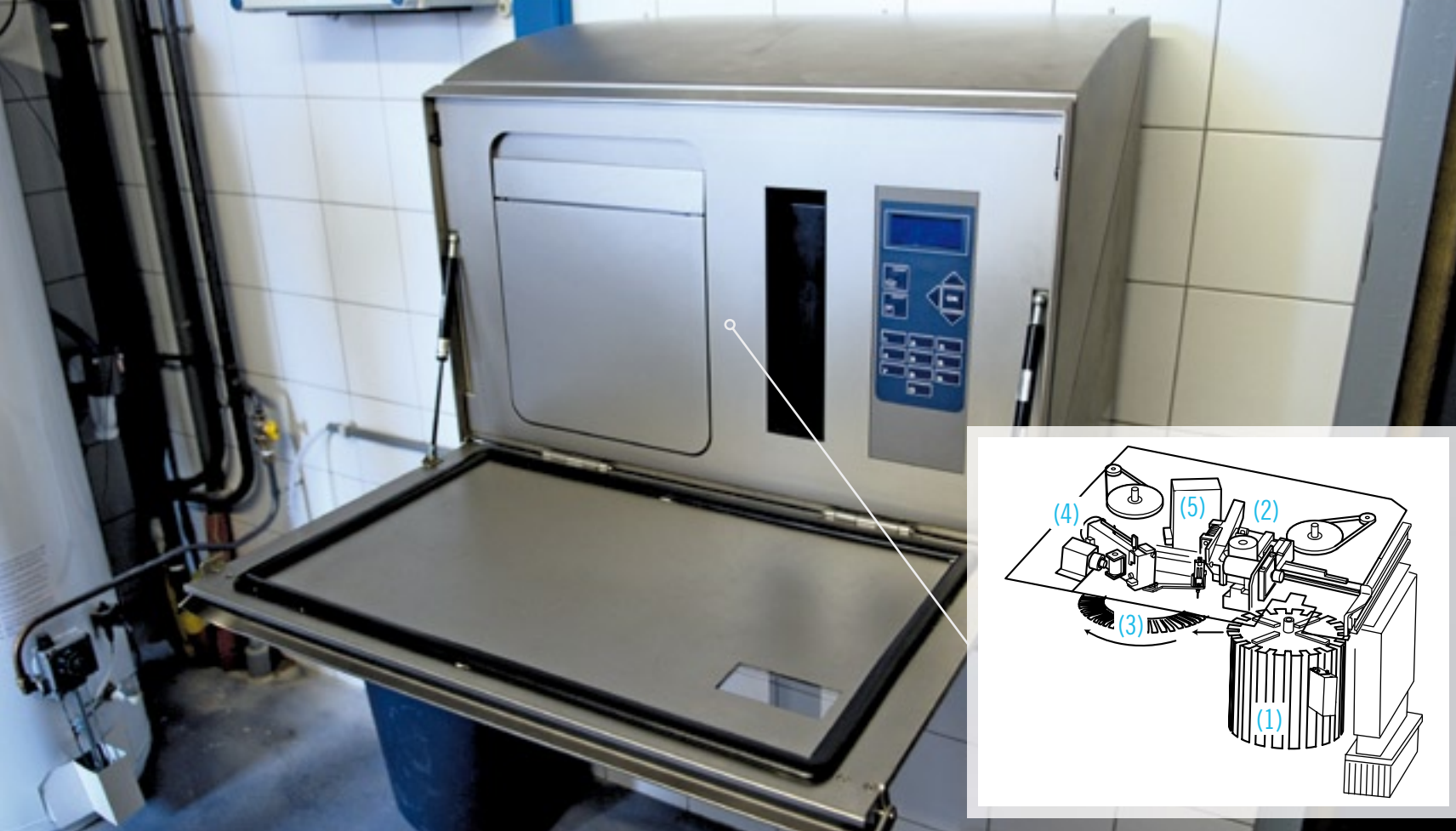
Tijdens de analyse van een melkmonster selecteert de Herd Navigator een cassette met teststaven uit de voorraadmodule (1), pakt de distributiemodule (2) een staafje en duwt die in de incubatorcarroussel (3). Er valt een druppel melk uit een doseermodule (4) op het staafje. De staaf draait langs een lezer (5) die de verkleuring analyseert.
