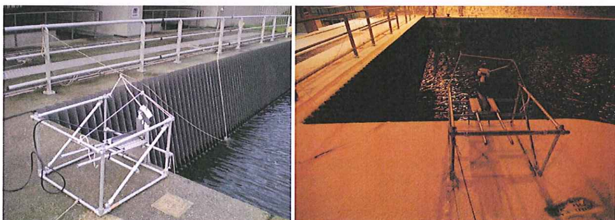
Foto 3.2. DIDSON opstelling bij het krooshek voor gemaalpompe 5 eind november (links) en eind december (rechts).
