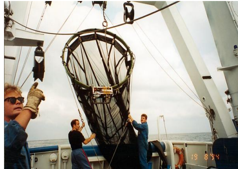
Het MIK wordt net gebruikt voor het vissen op haringlarven 's nachts
