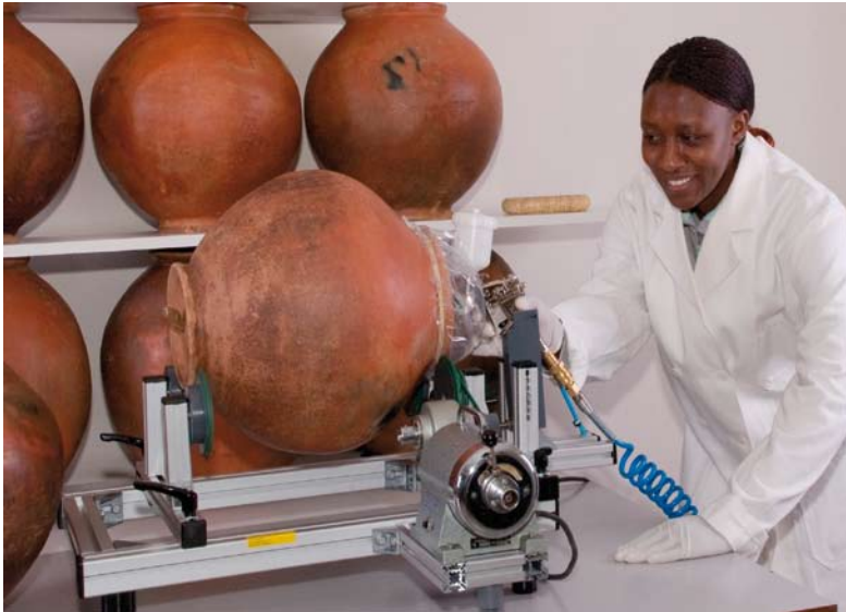
figuur 8 Traditionele waterpotten worden in het laboratorium behandeld met schimmelsporen
