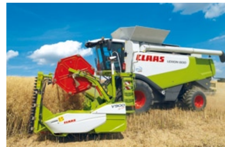
▲ Het Vario maaibord van Claas is tot 30 cm in breedte verstelbaar. Met speciale inlegplaten is de lengte maximaal 50 cm.
