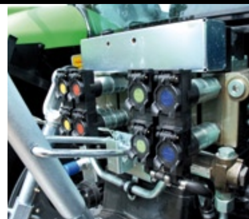
Er zijn maximaal vier elektrisch bediende dubbelwerkende ventielen beschikbaar op de traploze Agrofarm.
