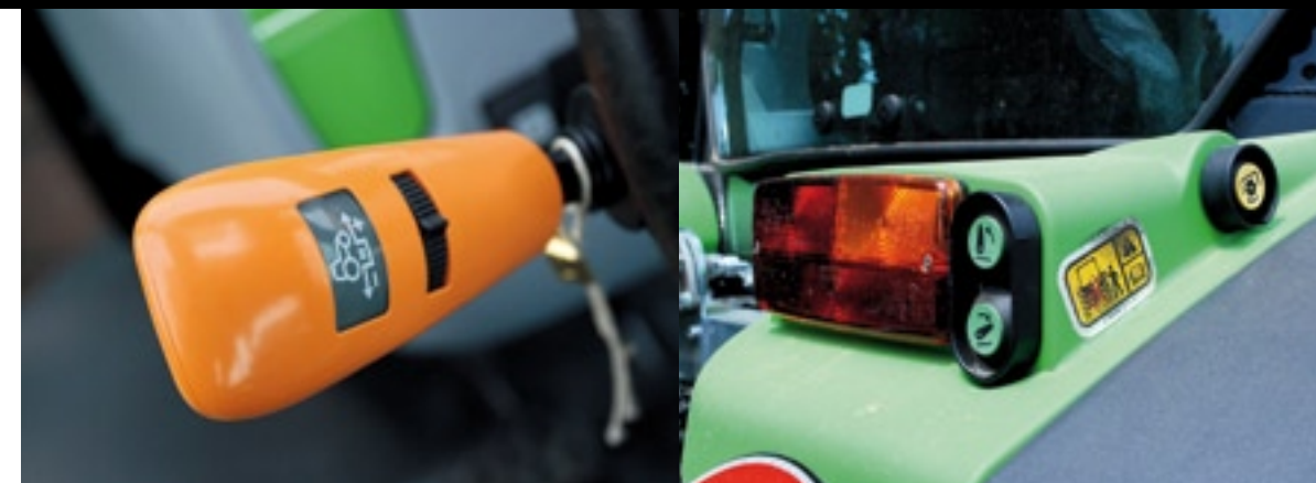
Op de omkeerhendel zit een knopje waarmee je de mate van aangrijpen van de omkeer kunt instellen. Handig bij voorladerwerk.
