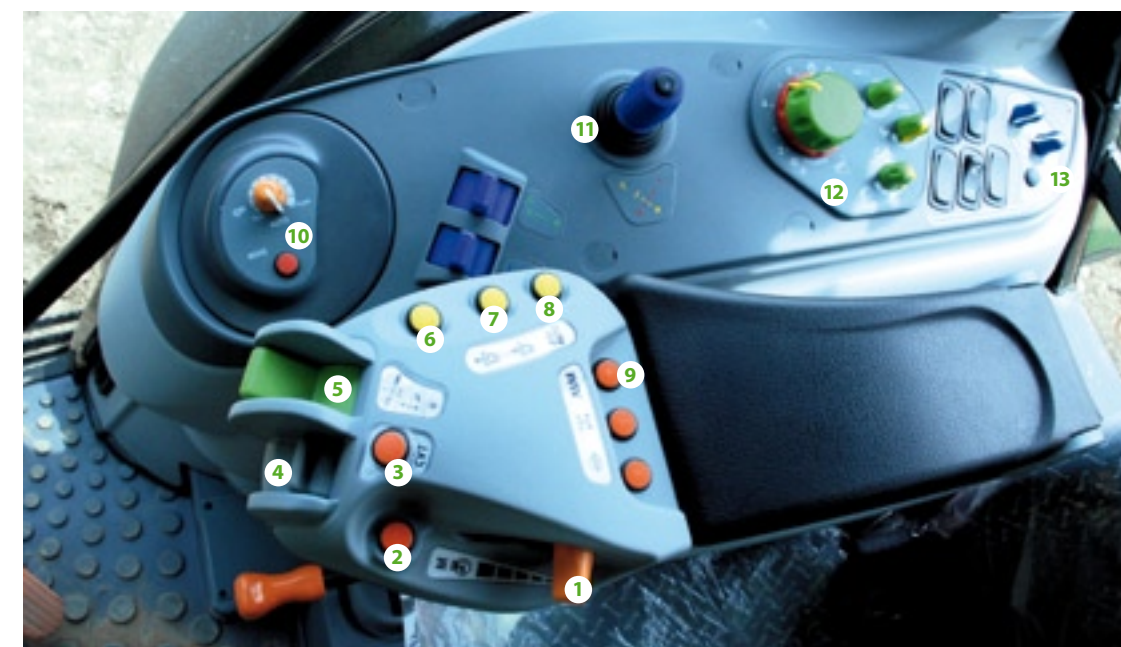
De traploze transmissie bedien je met een paar oranje gekleurde knoppen in de armleuning en met een draaiknop op het rechterconsole. 1: handgas; 2: geheugen motortoerental; 3: cruisecontrol; 4: flipper rijnsnelheid rijnsnelheid; 5: flipper hef; 6: frontaftakas; 7: achteraftakas; 8: automatische pto; 9: bediening kopakkermanagement; 10: draaiknop eco/power-stand; 11: bediening hydrauliek; 12: bediening hef; 13: doorstroomtijd hydrauliek.
