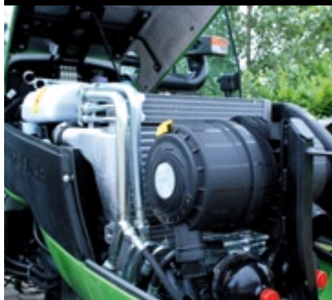
De Agrofarm TTV trekkers zijn voorzien van een elektronisch geregelde Deutz viercilinder. De motorkap gaat in een stuk open.
