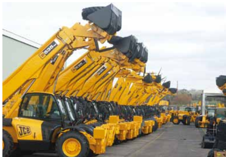
JCB heeft vrijwel alle verreikers reeds uitgerust conform de EN 15000-norm. Het merk koos voor een lastmomentbegrenzer die de belasting op de achteras meet.
