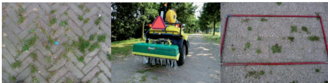
Figuur 2.4. Beeld van testvlakken in Wageningen, 2009, links rode klinkers en rechts betonklinkers, midden overzicht van proefstrook met machine met opvangzakjes voor afgiftemeting
