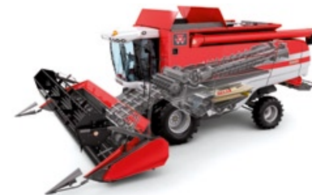
▲ De Massey Ferguson 9280 Delta is voorzien van een dorstroommel en twee grote dorsrotors.
