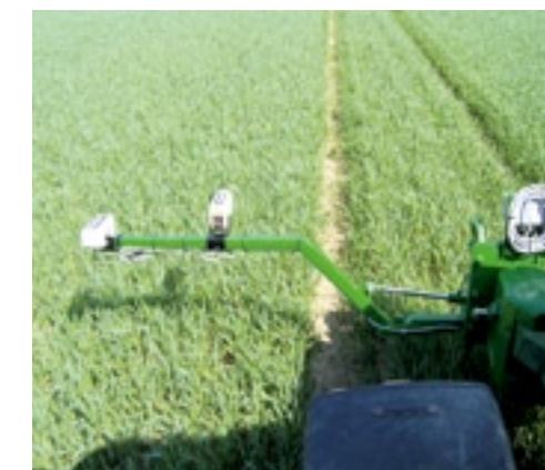
▲ De GreenSeeker werkt nu ook als stikstofsensor aan bijvoorbeeld de frontheft van een trekker.
