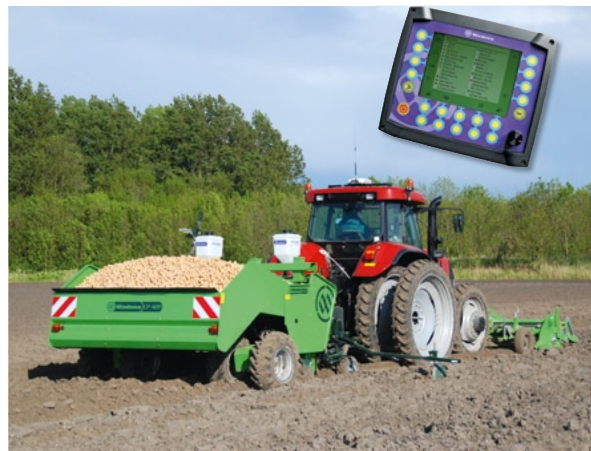
◀ De vierrijige CP bekerplanter is volgend jaar ook in een getrokken versie te koop. Machines met hydraulische aandrijving hebben de nieuwe HMI bedieningsterminal.
