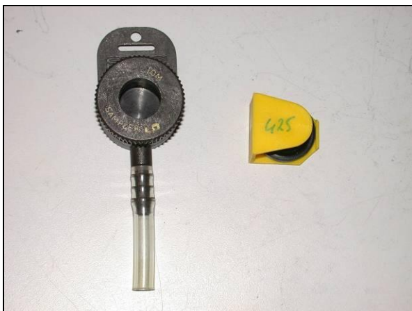
Figuur 2 Monsterapparatuur voor totaalstof. Links op de foto de monsterkop met aanzuigleiding naar de pomp; rechts op de foto de filterhouder met bescherming voor transport.
