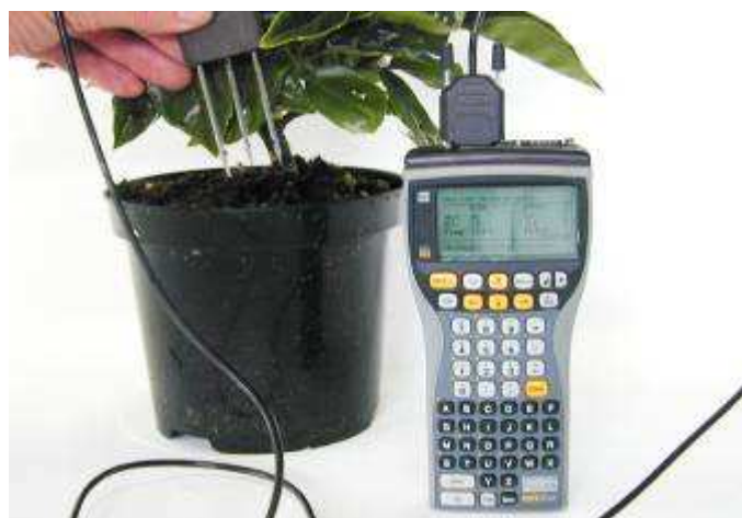
Met vochtsensoren meer zicht op het vochtverloop in de pot
