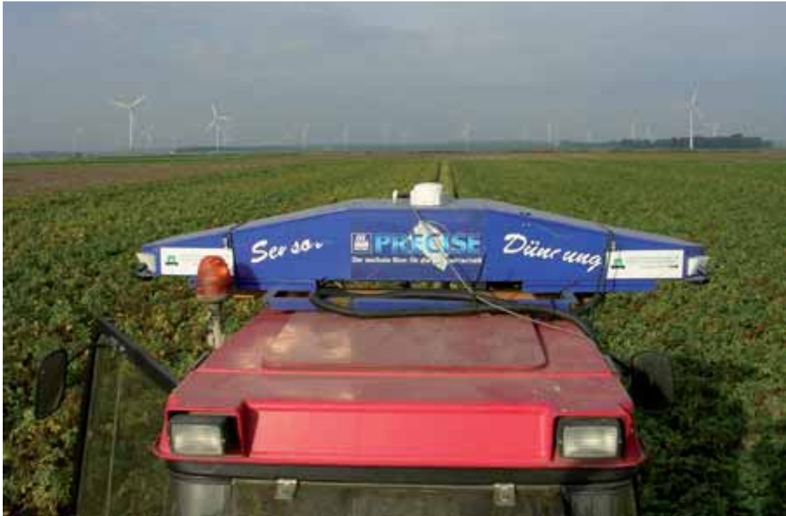
Figuur 5. De YARA N-Sensor voor de bepaling van de gewasreflectie. Boven op de sensor is de DGPS ontvanger geplaatst (het witte bolletje in het midden).
