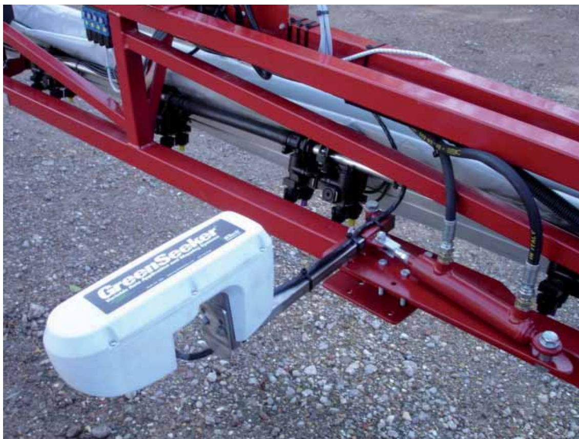
Figuur 6. Een van de zeven GreenSeeker sensoren op de spuitboom van de SensiSpray machine.
