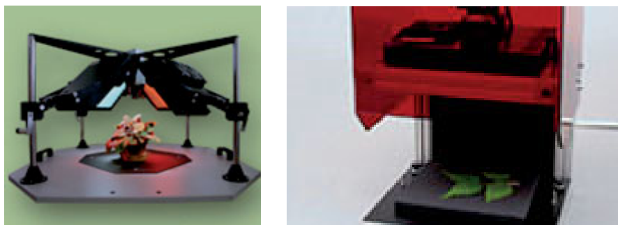
Figuur 8. Links een chlorofyl fluorescentie camera, Fluorcam, voor het screenen op fotosynthese activiteit en groei van Photon Systems Instruments ( http://www.psi.cz ). Standaard kan een oppervlak van 20x20 cm 2 worden opgenomen. Rechts een Imaging PAM van de firma Waltz voor het opnemen van chlorofyl fluorescentie beelden van een oppervlakte van maximaal 10x13 cm 2 ( http://www.walz.com ).
