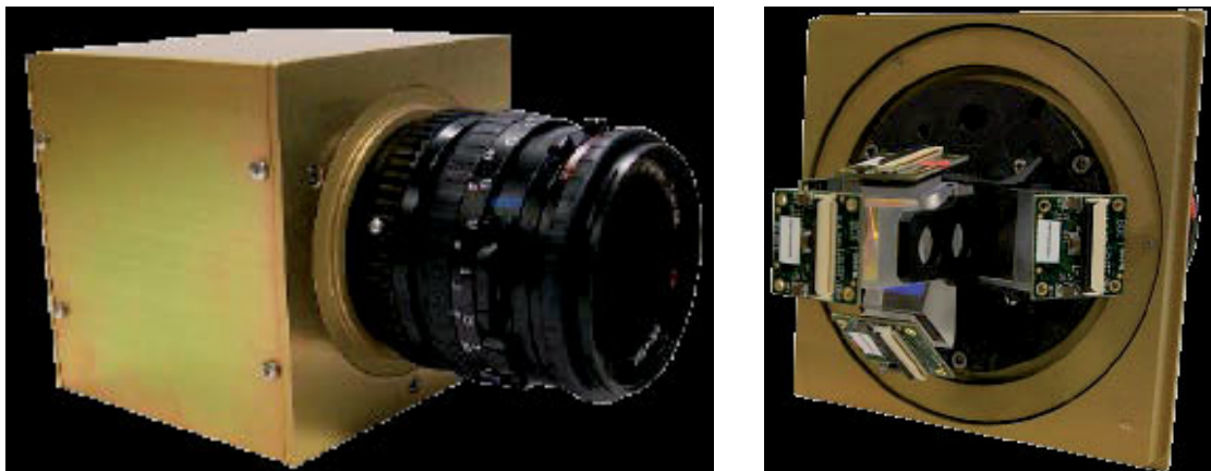
Figuur 5. Camerasysteem van de firma Quest innovations bestaande uit vijf individuele CMOS-beeldsensoren (10-bit=1024 grijswaarden) voor het gelijktijdig opnemen van vijf spectrale beelden. Rechts een beeld van het inwendige ( http://www.quest-innovations.com ).
