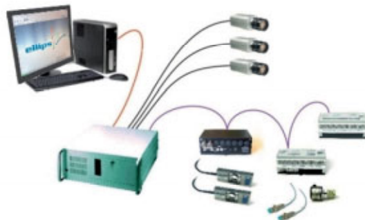
Figuur 11. Multi camera systeem EFG400 van de firma Ellips voor het meten van kleur en dimensies van agrarische producten ( http://www.ellips.nl ).
