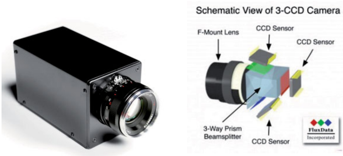
Figuur 4. 3CCD camera (14-bit=16384 grijswaarden) van de firma FluxData waarmee simultaan met drie beeldsensoren in drie afzonderlijke spectraalgebieden naar klant specificaties beelden kunnen worden opgenomen. Tevens heeft dit model een ruime keuze aan beeldsensoren van 1.4, 2.0 of 5.0 Megapixel ( http://www.fluxdata.com ).
