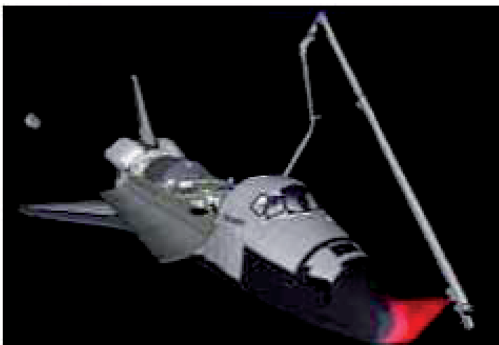
Figuur 12. De laser camera system, LCS, van de firma Neptec Design Group gemonteerd op de arm van de Spaceshuttle voor het inspecteren van de hittetegels ( http://www.neptec.com ).
