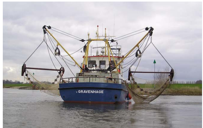
Figuur 22 Onderzoeksvaartuig Schollevaer, met aan weerskanten een garnalenkor boven het water gehesen.
