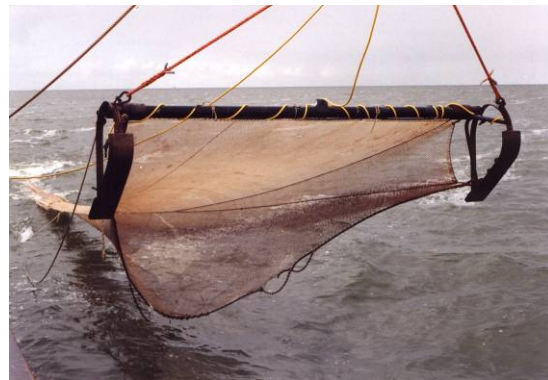
Figuur 19 De elektrokor, waarmee de bestandsopnames op het IJsselmeer worden uitgevoerd. Let op de gele kabel, die om de boom gewonden is, waarmee de sloffen (links en rechts) van een elektrische spanning voorzien worden.
