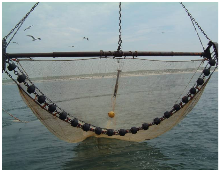
Figuur 26 De 6-m boomkor die in het Dutch Young Fish Survey DYFS wordt gebruikt. Op de achtergrond is de duinenrij te zien.
