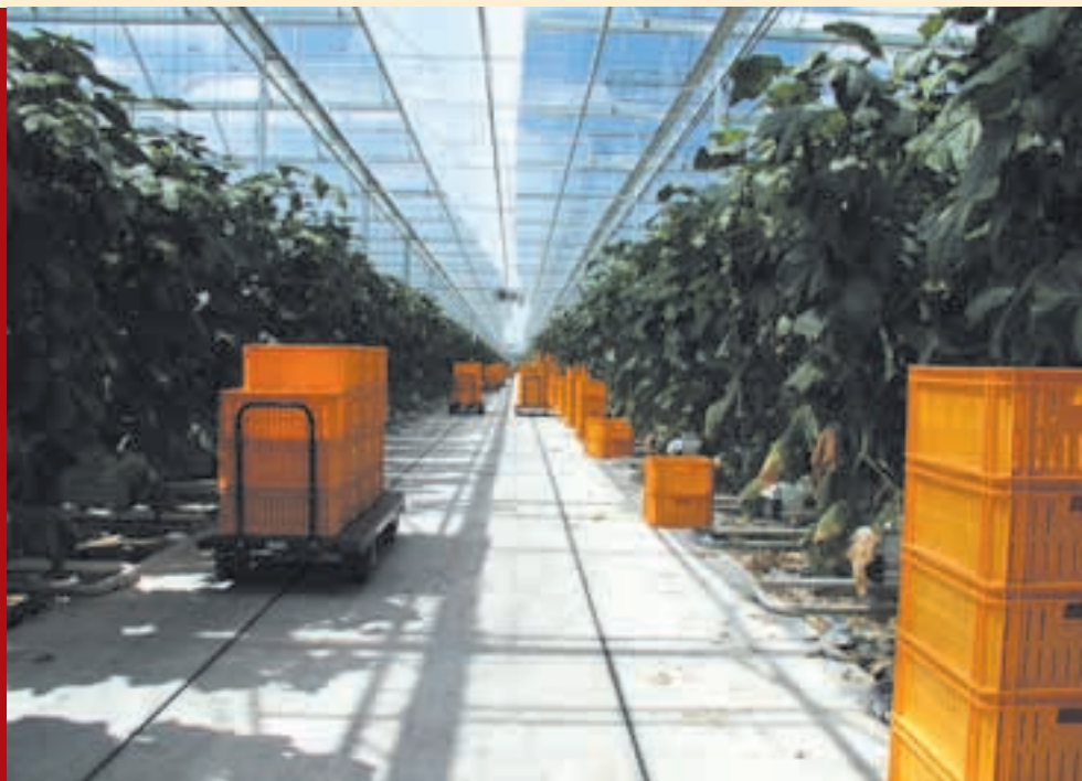
Een teler kan gewoon de pen van de kar in de gleuf met ketting laten vallen en de kar is onderweg. Zo veroorzaken de karren geen overlast op het betonpad.
