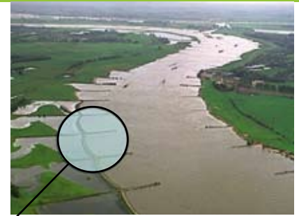
Figuur 1 Kribben langs de Waal. Door de kribben met circa 2 meter te verlagen wordt de hydraulische weerstand verminderd en kan er meer water per tijdseenheid door dit riviertraject stromen.
