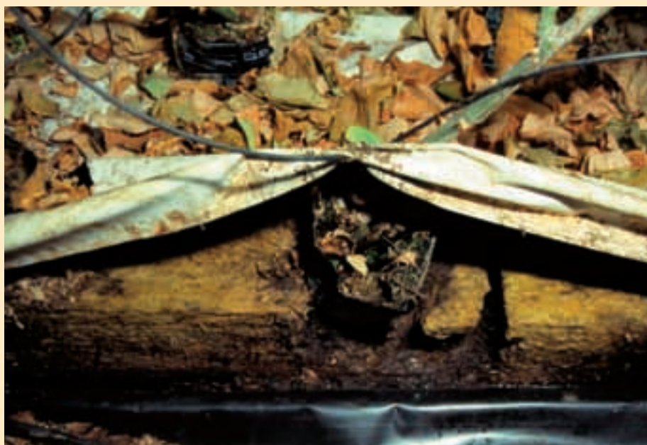
Bij een te lage pH lost zelfs de steenwolmat op
