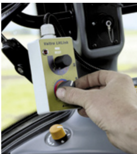
▲ Met het LHLink bedieningskastje in de cabine bepaal je of de hef automatisch met de voorwielen meedraait of niet.
