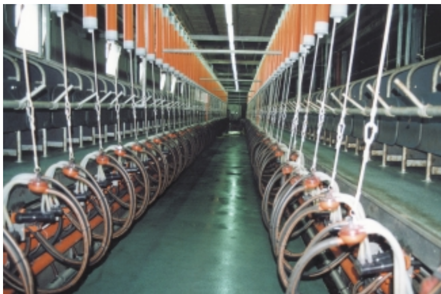
Met de 130-stands melkstal kunnen 130 geiten tegelijkertijd worden gemolken
