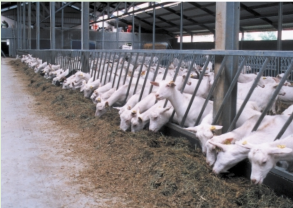
In de volledige lengte van de stal is vanaf een 0,5 m vanaf het voerhek een coating op het beton aangebracht
