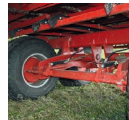
De tandemas van de MH maailaadcombinatie combineert de eigenschappen van een pendelende tandem met een boogje as.
