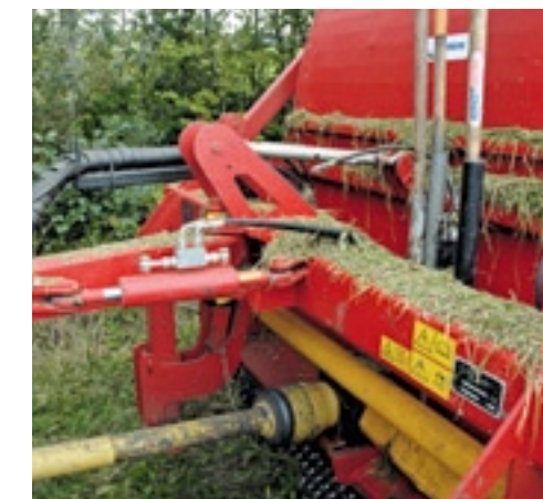
De MH ML 190-14 heeft een disselbesturing om een sideshift te creëren, maar ook een combinatie met knikdissel is mogelijk.
