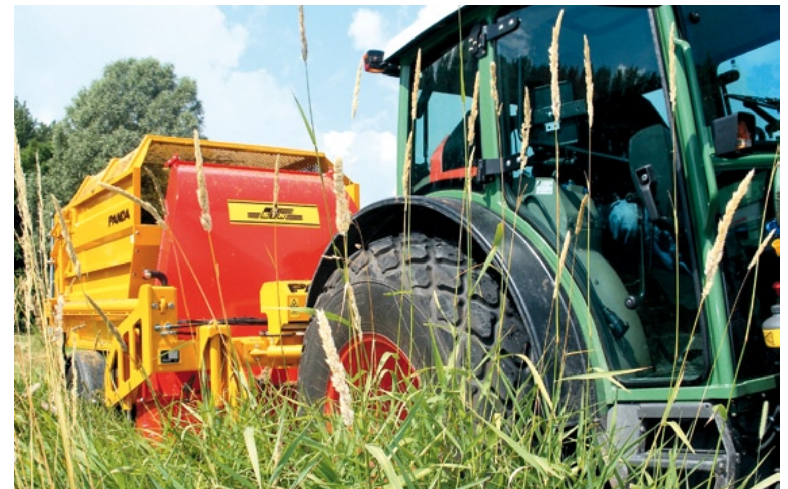
Schouten maakt een min of meer standaardmachine met STH Panda 1806. Deze maait 180 cm breed en heeft een 6 kuubs opvangbak.
