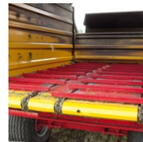
De bodemketting van de MH is dubbel uitgevoerd. Door de achterklep te vergrendelen kan de bodemketting ook verdichten.
