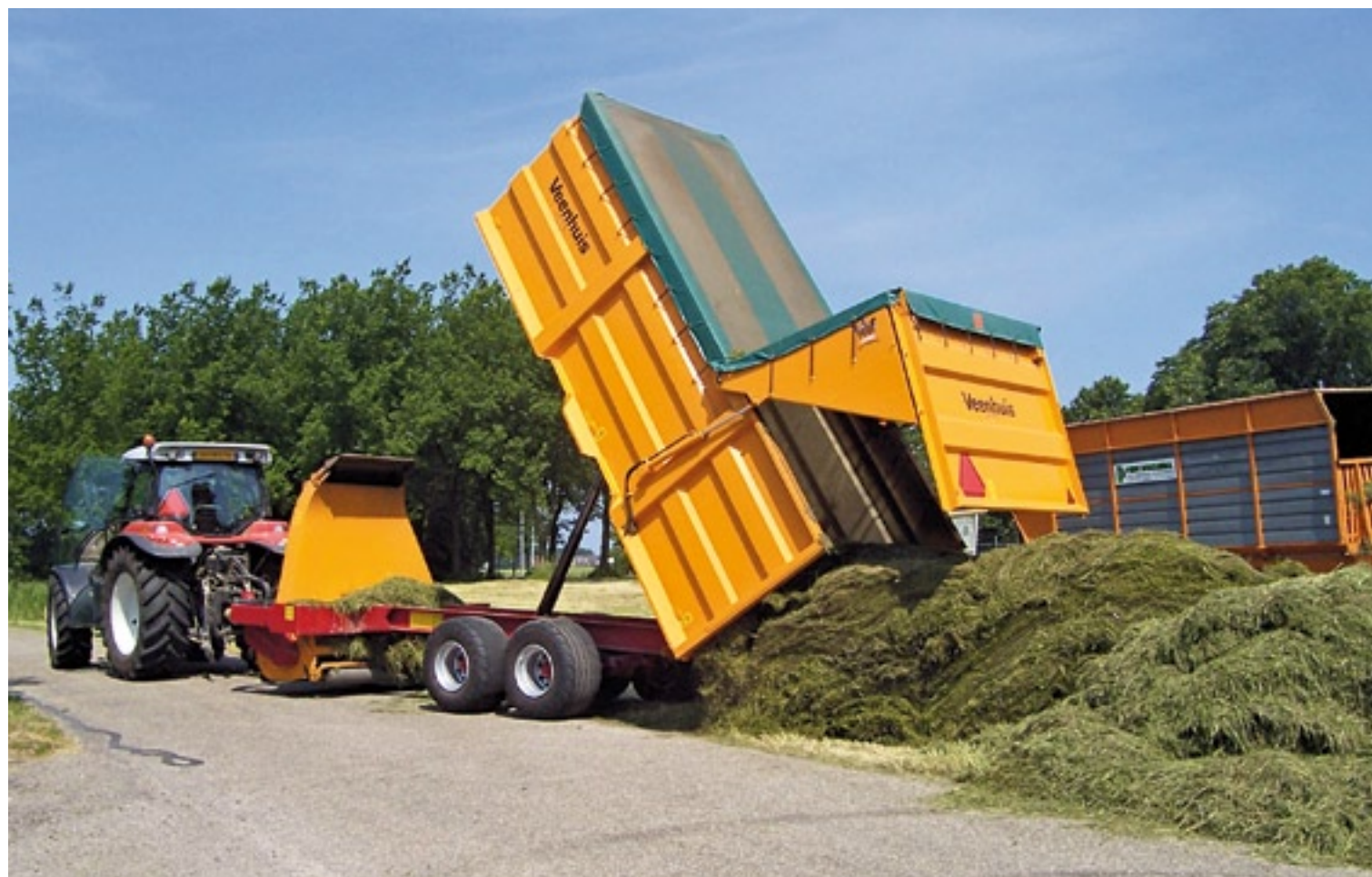
Naast Omarv maailaadwagens met hoogkipper levert Wim van Breda voor het zwaardere bermenwerk ook een Omarv TER190 met 11 kuubs Veenhuis kipbak.
