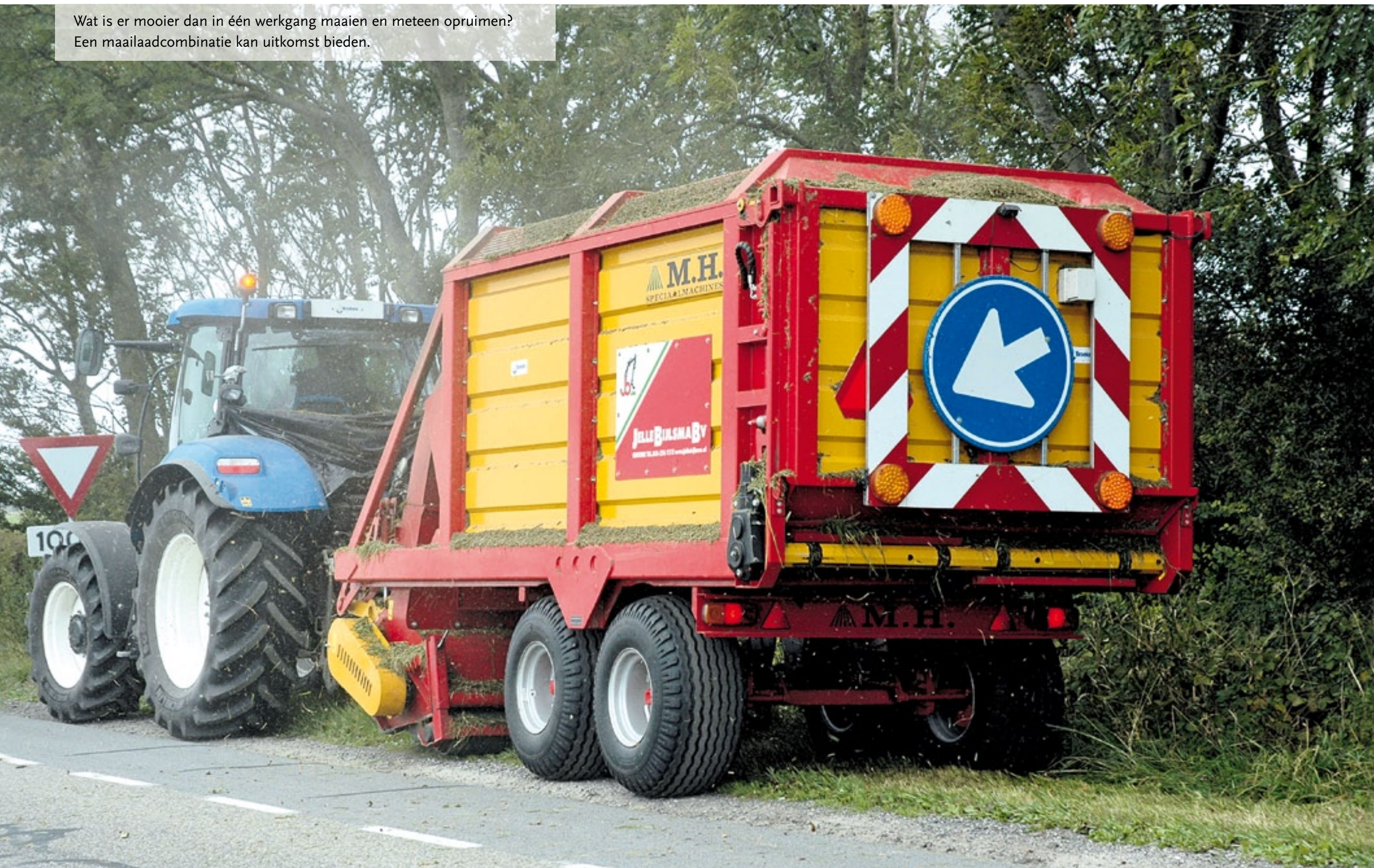
De MH ML 190-14 heeft een disselbesturing om een sideshift te creëren, maar ook een combinatie met knikdissel is mogelijk.
