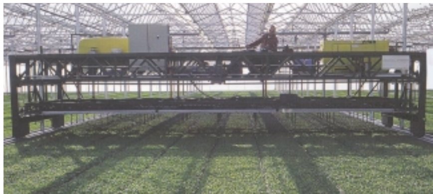
Strokenfundatie gebruikt voor de geleiding van intern logistiek systeem
