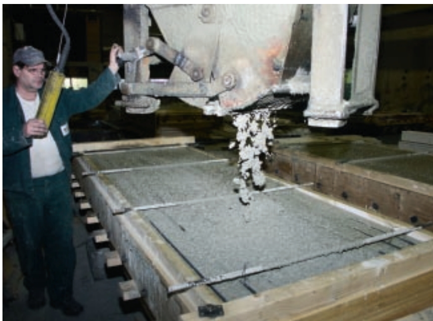
De productie van de vloer met hoogovencement gebeurt in een mal
