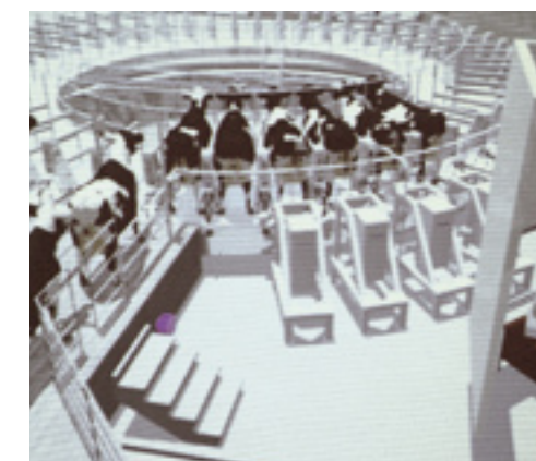
DeLaval onderzoekt verschillende mogelijkheden om robotmelken in een carrouselmelkstal, zowel bij een buitenmelker (links) als een binnenmelker (rechts), mogelijk te maken.
