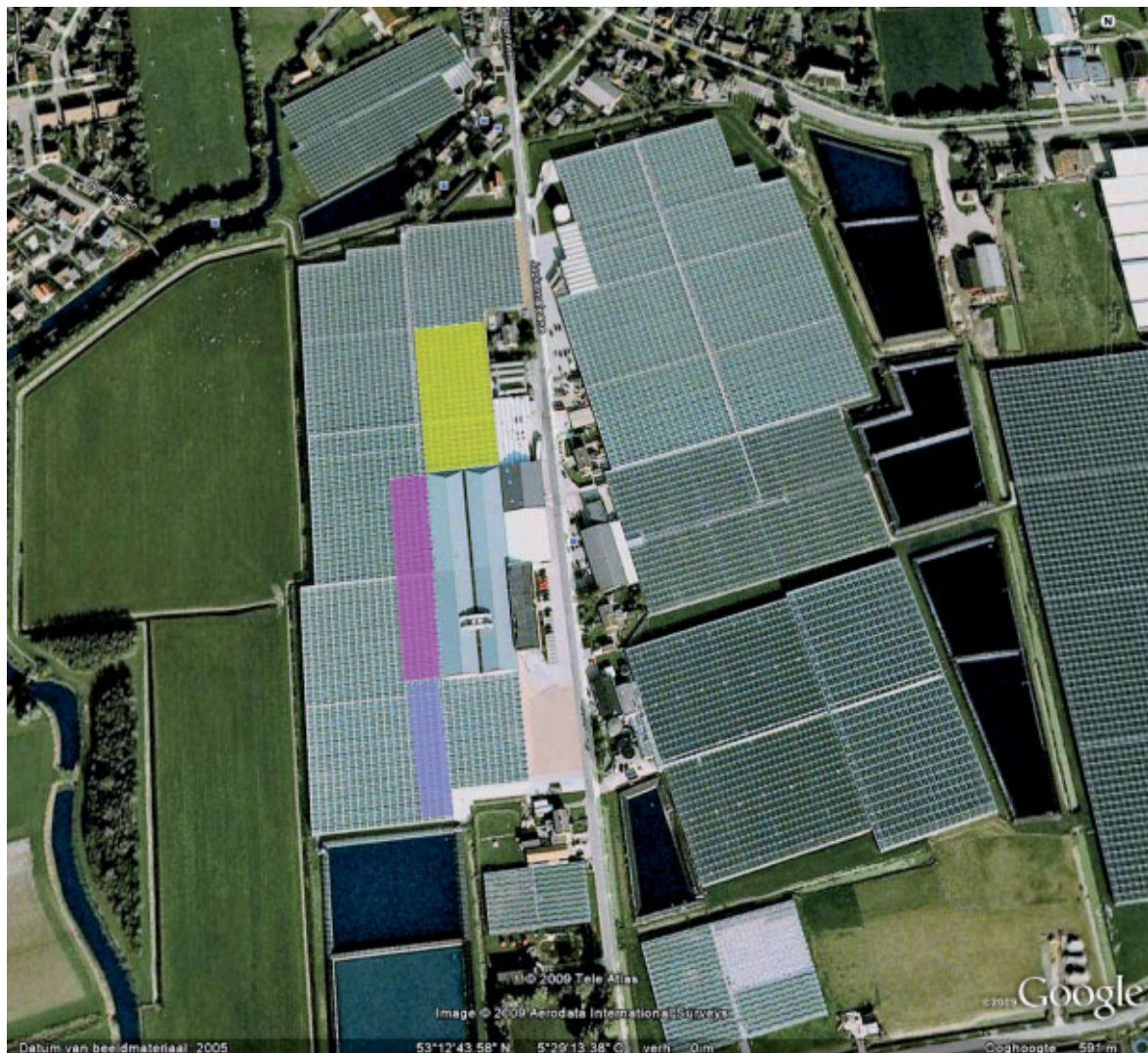
Figuur I-1. Boveraanzicht van de kassen van firma Hartman in Sexbierum. De gekleurde vlakken geven de locatie van de verschillende behandelingen aan. De oppervlaktes van de vlakken zijn niet op schaal. Het grijze vlak links van de weg beslaat het onbelichte proefveld, het rose vlak beslaat het LED-proefveld en het gele vlak beslaat het SON-T proefveld. Rechts van het LEDproefveld en onder het SON-T proefveld, is de bedrijfshal.
