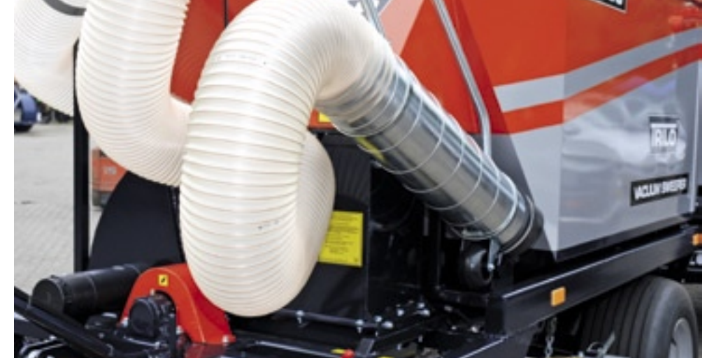
■ Een zuigwagen met een zuigmond onder de wagen en een zuigslang die hydraulisch bedienbaar is. Deze slang kan ook door een hydrauliekmotor een pendelende beweging maken om bladrillen op te zuigen.
