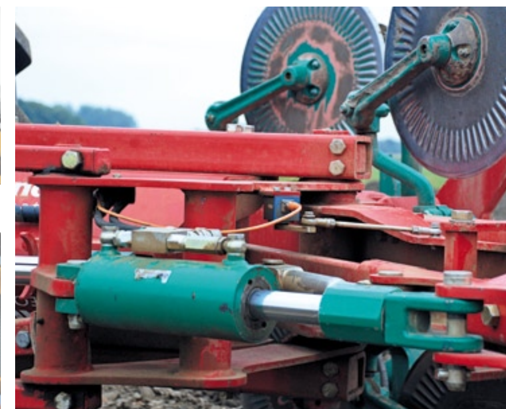
▲ De MCF ploegbesturing stuurt bij bovenover ploegen de trekker en de breedtestelling via een hydraulische cilinder aan. Bij ploegen in de voor is dit alleen de ploeg, anders loopt de trekker uit de voor.
